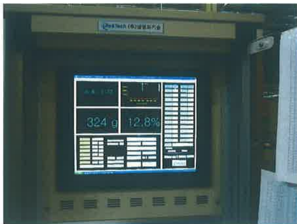
圖2 光波選別機顯示重量及糖度
