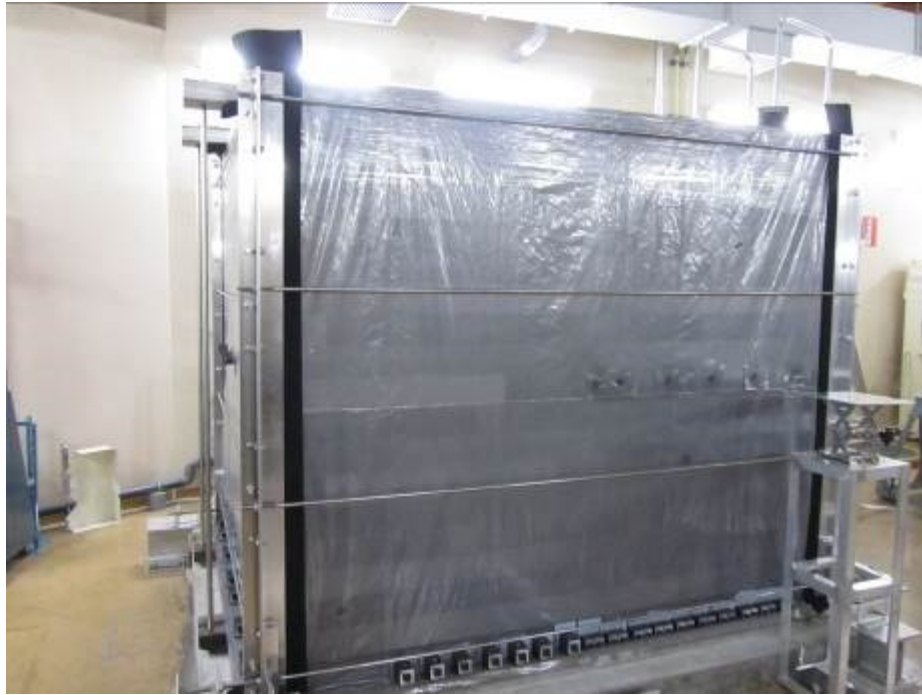
圖 2.11 日本 NMIJ 之石墨管中子原級校正系統
