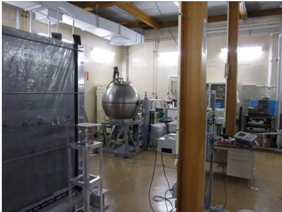
圖 2.10 日本 NMIJ 之硫酸錳浴中子原級校正系統
