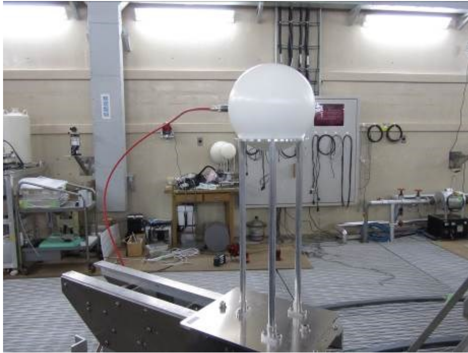
圖 2.9 日本 NMIJ 之波那球中子量測系統
