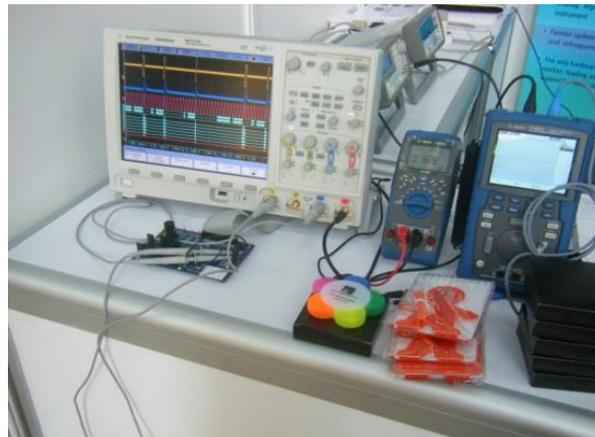
圖 23 即時 EMI 分析儀與高速示波器之整合設備
