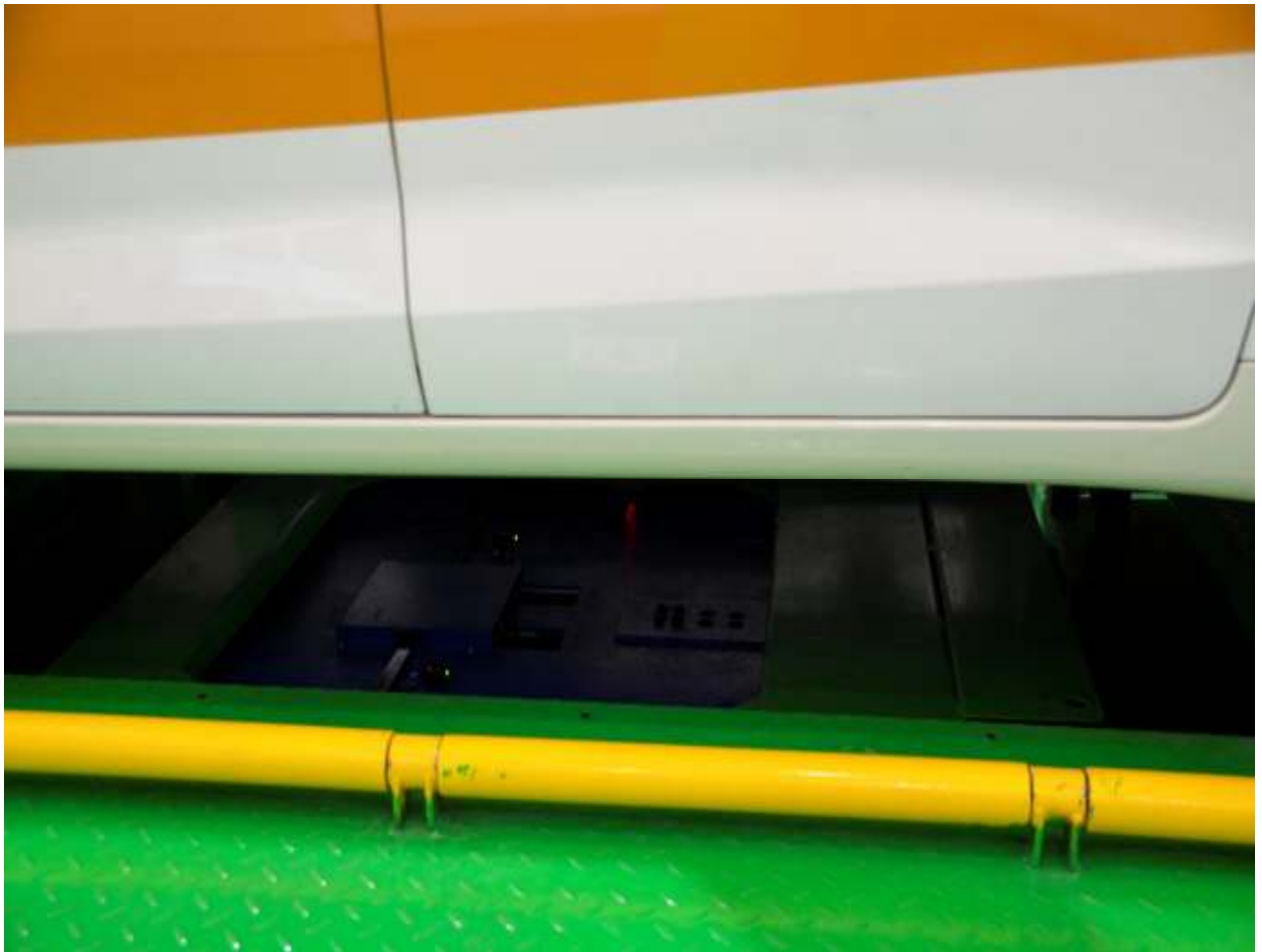
圖 45 上海電巴新能源科技公司展示的換電系統，藉由精準的定位進行底盤電池的更換
