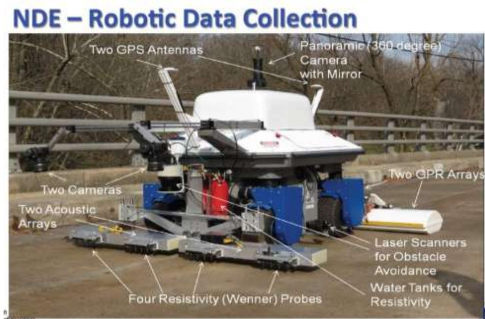
圖 4-2 非破壞性監測數據收集分析儀
