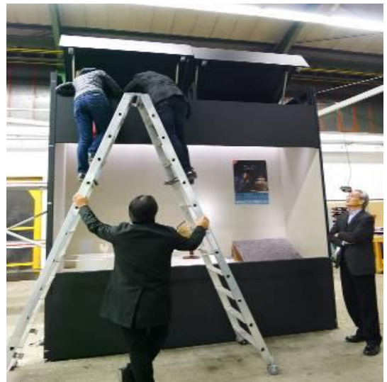
樣品櫃測試：本院人員登梯勘查維修門開啟順暢度以及燈具安裝與維修之方便性
