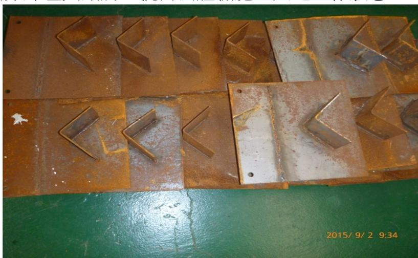
(生鏽之鋼板需進行預洗、手工具與電動工具打磨)
