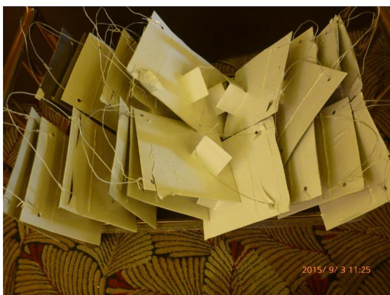
(樣品鋼板於第二道面漆塗佈後的狀態，並需進行相關檢測工作評估品質)
