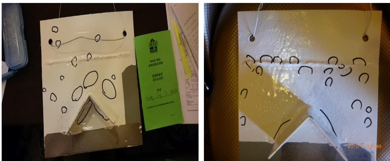
(樣品鋼板使用低壓漏塗點檢測儀檢測漏塗點，並將缺陷圈劃註記於記錄本中)
