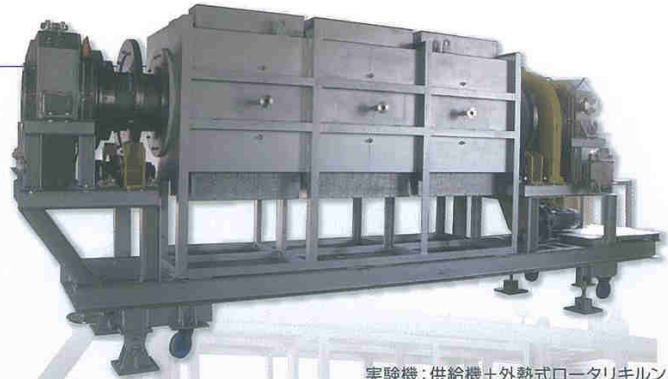
実験機：供給機＋外熱式ロータリキルン Testing machine; Feeder + External heating-type rotary kiln
