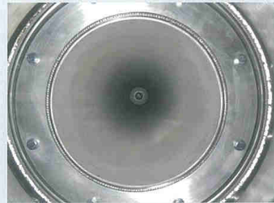
内面溶射構造のレトルト Ceramic spraying tube
