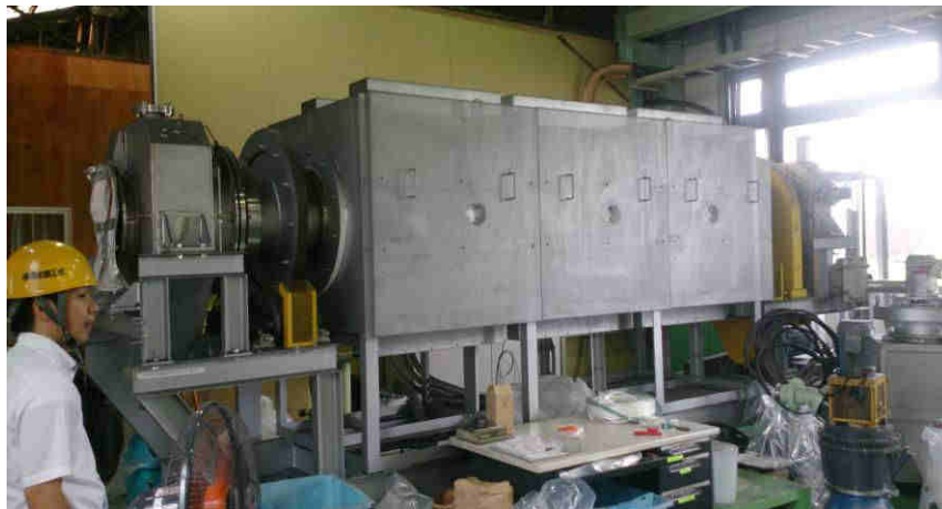
内面溶射構造のレトルト Ceramic spraying tube
