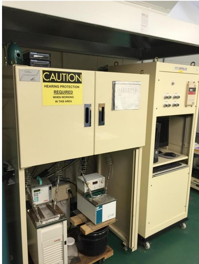
圖 8. PCT 吸放氫測試設備
