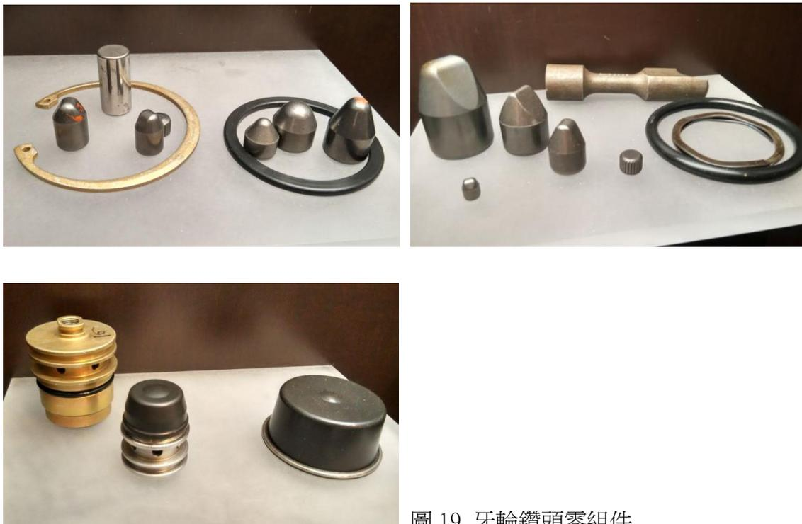
圖 19 牙輪鑽頭零組件
