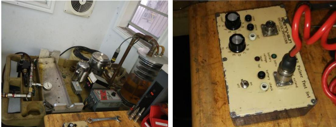
圖 29 (A)造波器及其換油設備 (B)造波器測試盒
