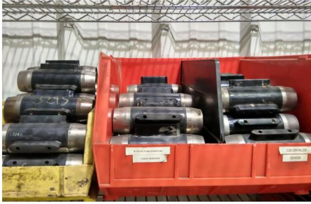
圖 25 不同尺寸找中器 (橡皮材質)
