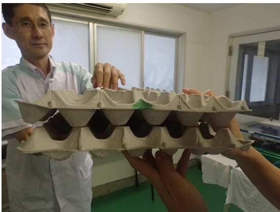
圖 18、蛋盤。大於 10 枚胚蛋包裝用。角落充填高分子聚合材料避免胚蛋破損。
