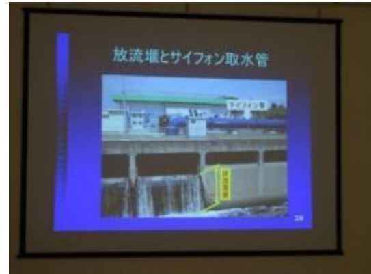
圖 38 森ヶ崎水再生中心設置小水力発電示意图
