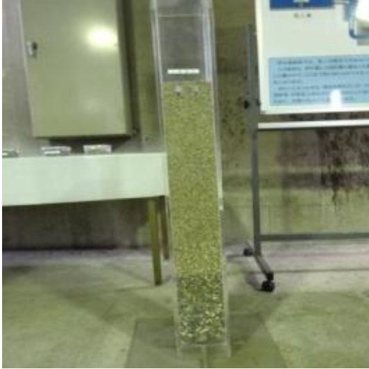
圖 17 落合再生水廠使用之砂濾系統剖面示意圖
