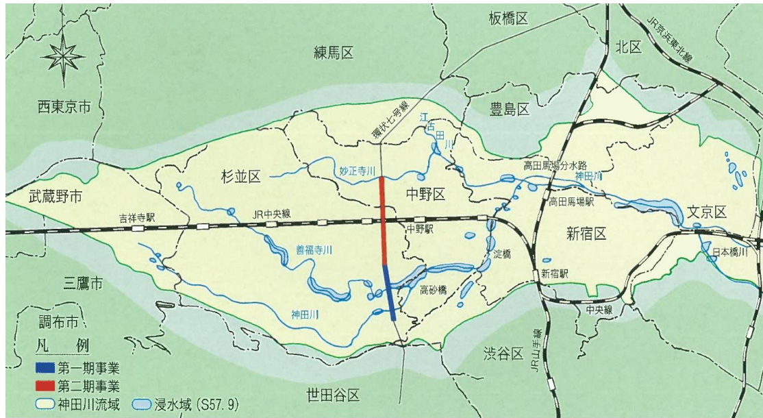
圖 64 神田川環狀七號地下調節池配置 (紅色為二期工程、藍色為一期工程)
