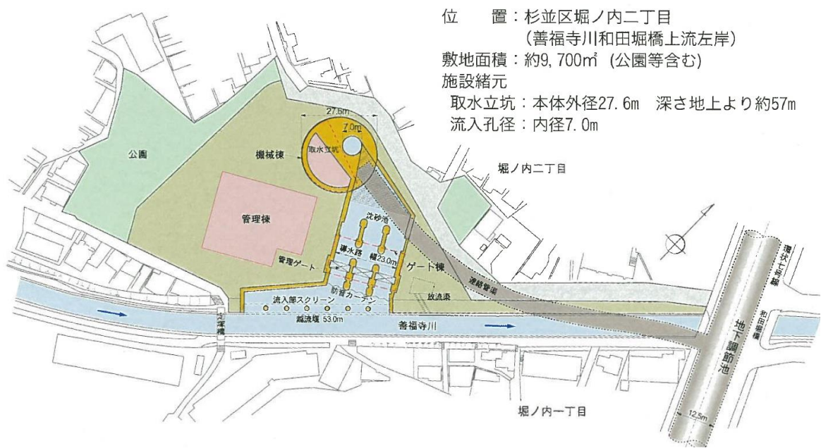
圖 68 善福寺川取水滯洪設施平面配置
