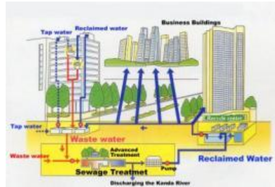
圖 24 落合再生水廠供應大樓沖廁用水示意圖
