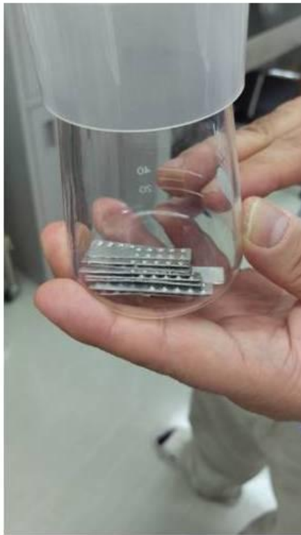
圖九、長期遺傳資源保管設施之果樹芽體保存樣品瓶(左)及鋁製樣品承載片(右)
