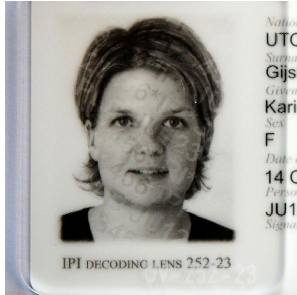
圖 19. IPI 必須使用簡單的解碼(透鏡)裝置才可判讀隱形個人信息
