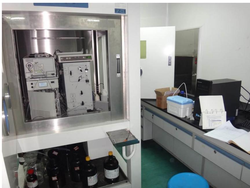
圖37 分析級Radio-HPLC
