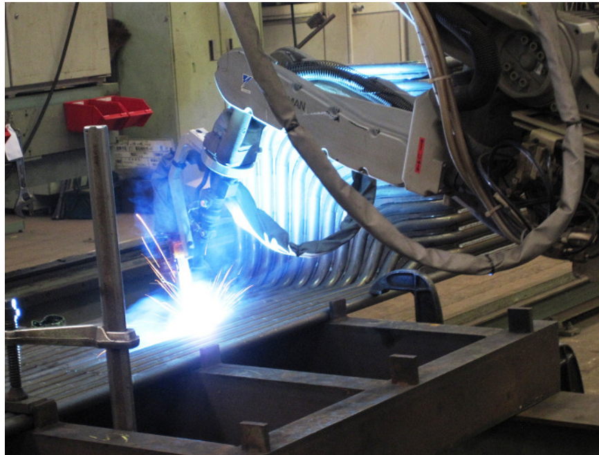
(b)爐管自動銲接
