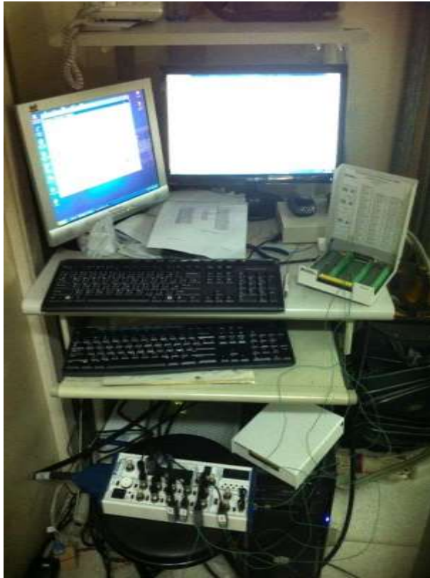
圖 3 南部電廠 GT11、GT12 系統數位訊號 (Analog signal) 擷取 A/D 介面顯示圖
