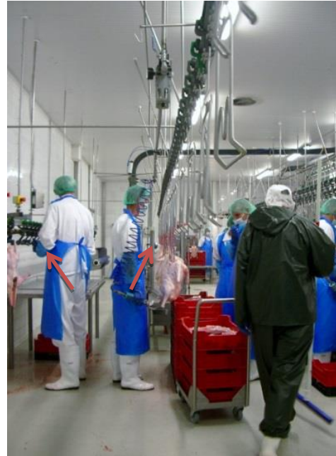
右邊箭頭為掛頸去鎖骨後再去除頭頸之屠宰線；左方屠宰線為接續右方屠宰線之程序，改以倒掛取內臟
