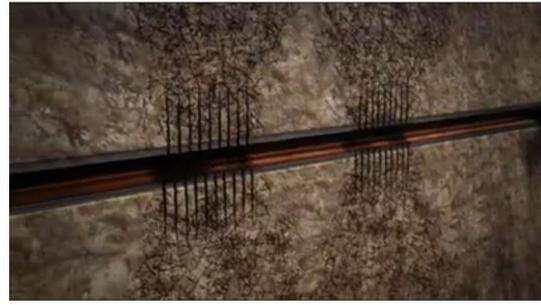
Step6. 注入高壓液裂流體形成人工裂縫
