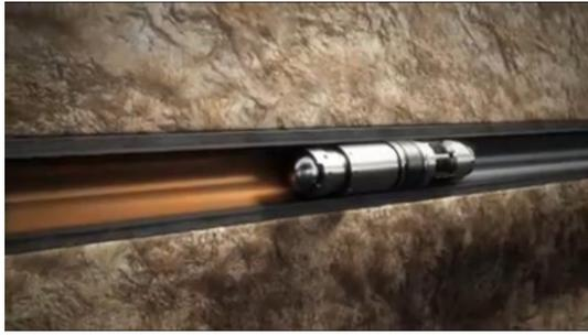
Step5. 高強度液裂球形形成封塞
