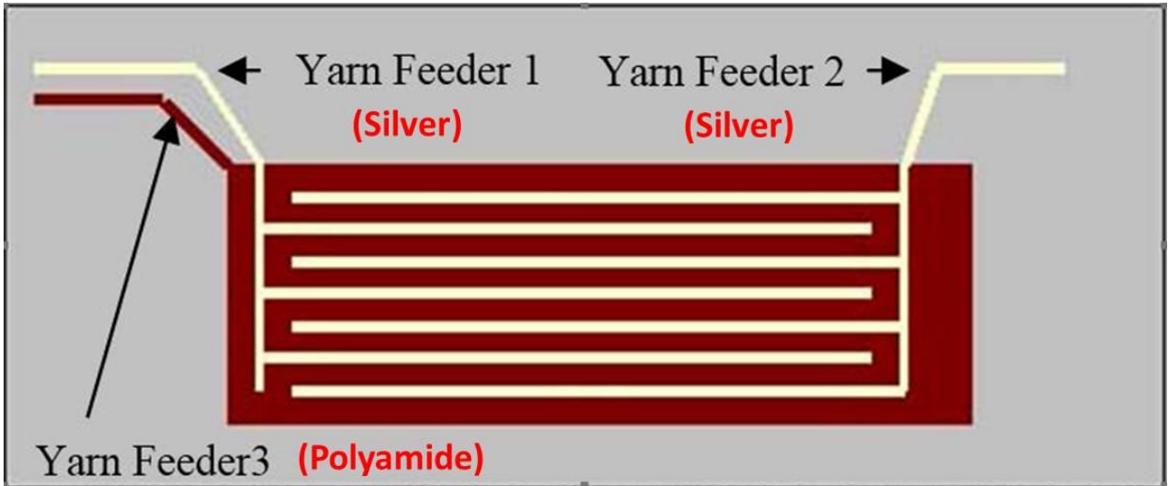
圖 15. 以針織機製作梳狀電極之進料示意圖
