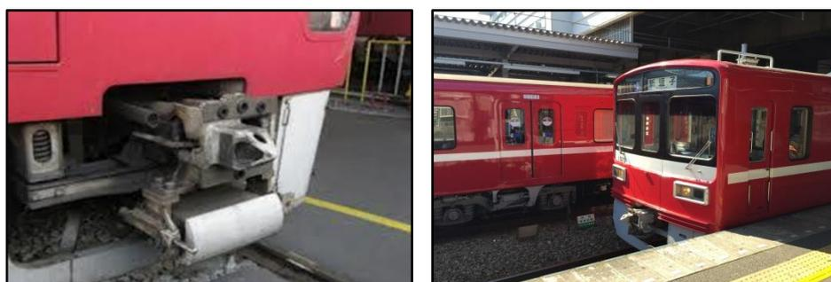
圖 2.33 京急電鐵電車自動連結器
