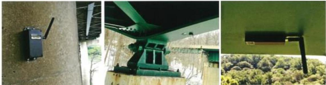
偵測端安裝於結構物上：RESENSYS 照片
