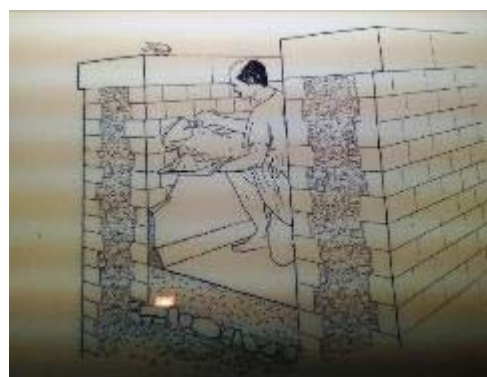
水道橋內部防水粉刷
