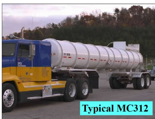
圖 3、MC 312 中壓(腐蝕性)槽車
