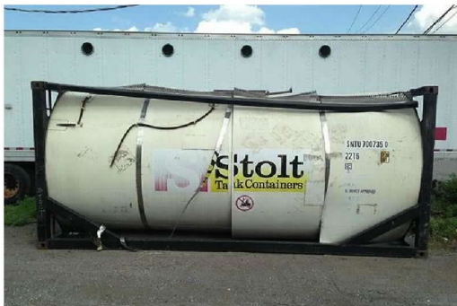
圖22、ISO TANK外套破裂
