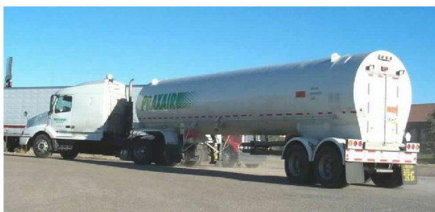
圖5、MC-338高壓化學槽車
