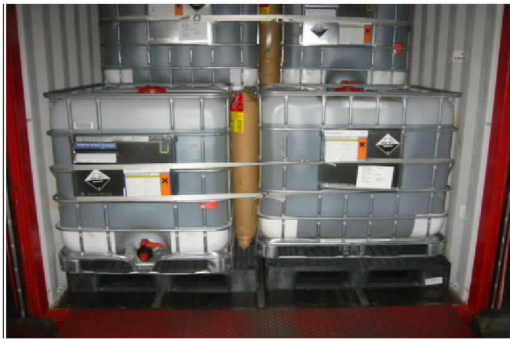
圖12、貨物固定與間隙填充
