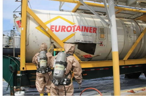
圖22、ISO TANK槽體止漏
