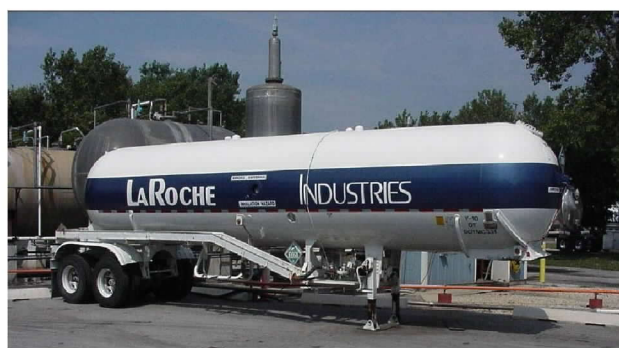
圖 4、MC-331 高壓化學槽車
