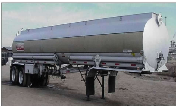
圖1、MC-306非壓力式槽車
