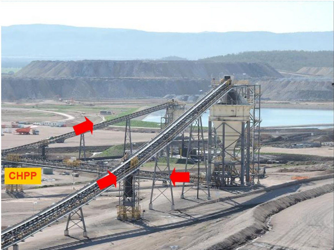
圖130 Maules Creek礦區產品煤輸送系統
