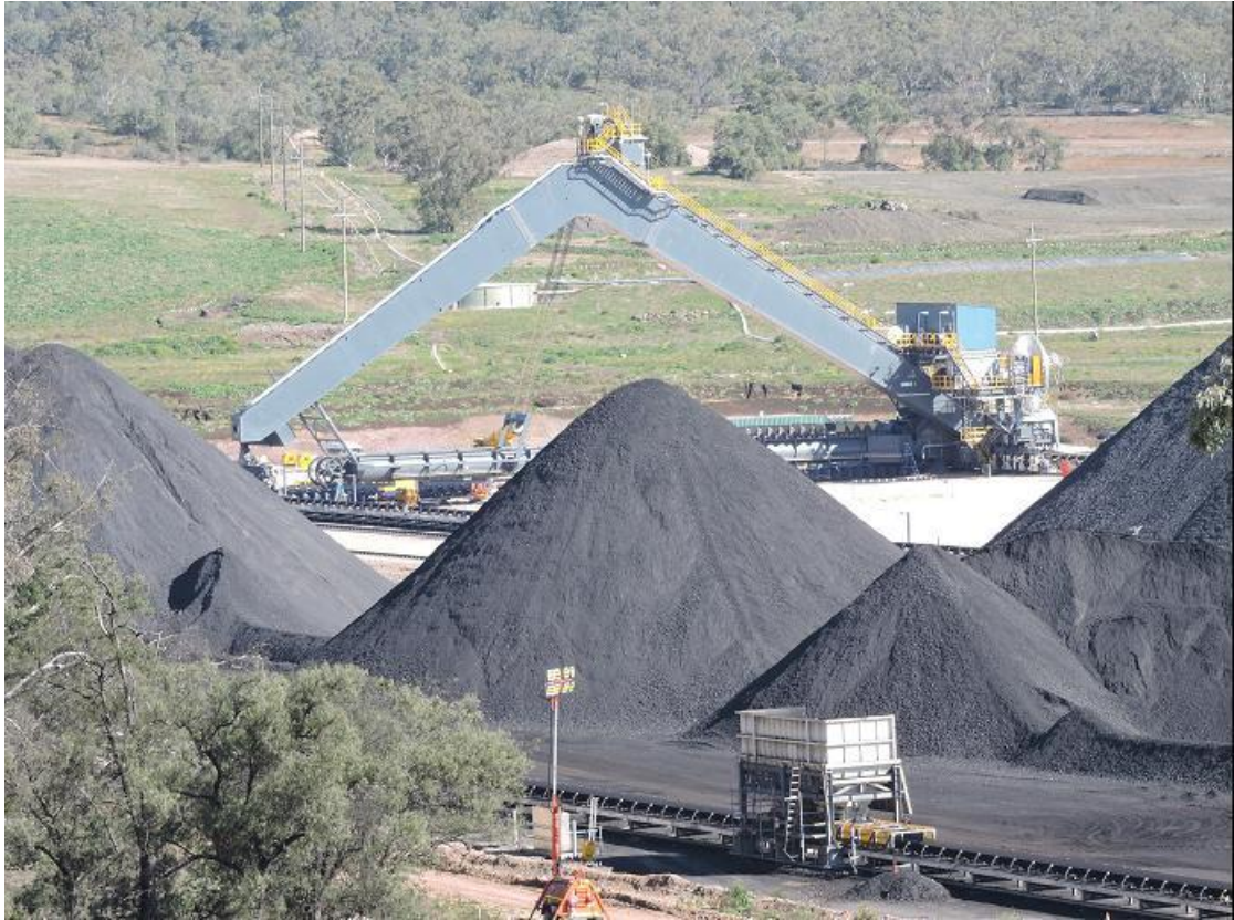
圖132 Maules Creek礦區產品煤儲煤場與取煤機
