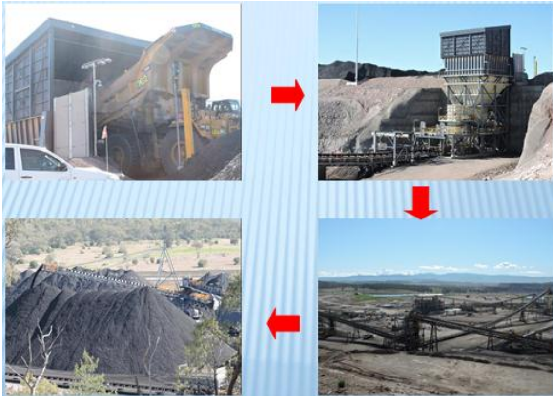
圖128 Maules Creek礦區原煤碎煤作業
