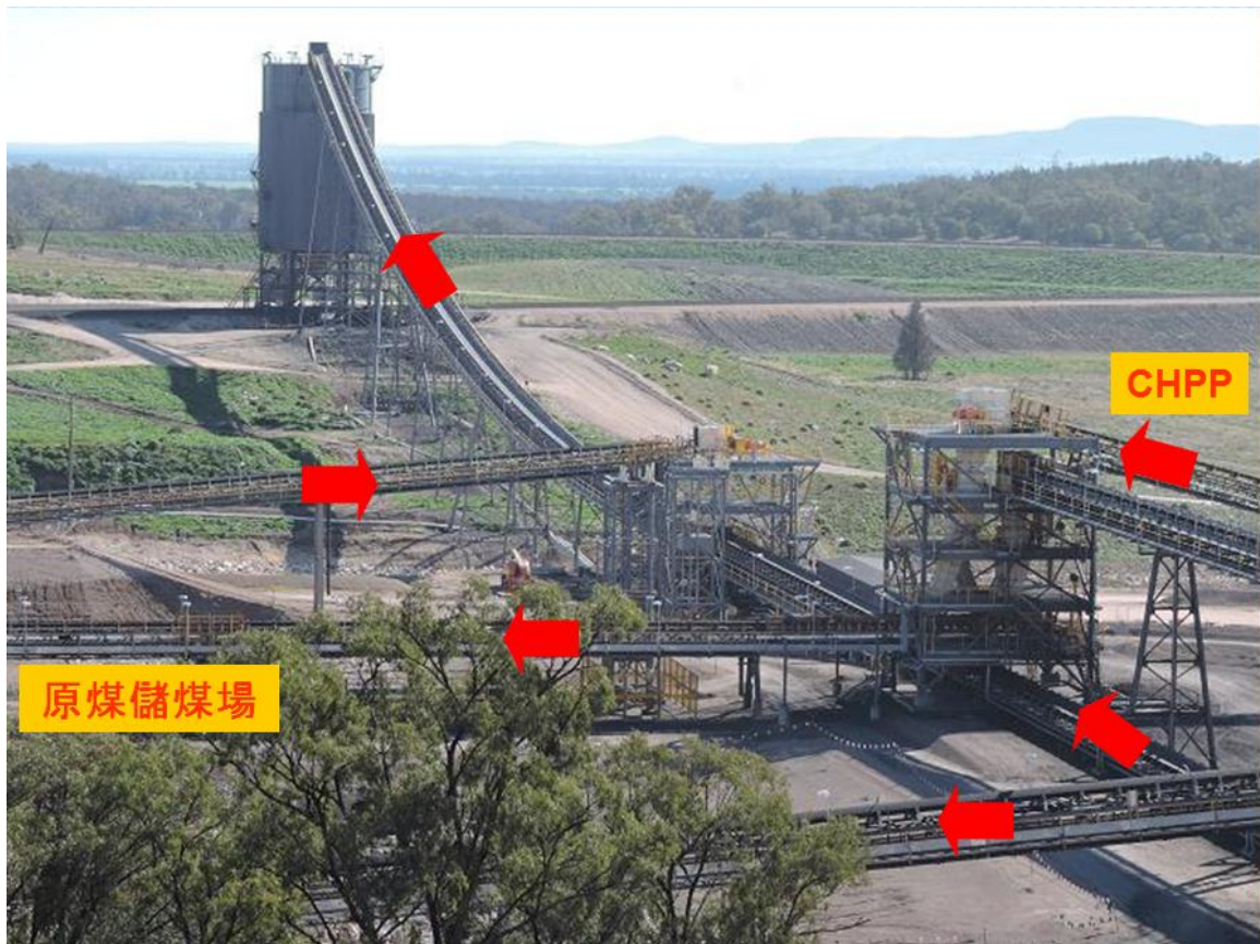
圖129 Maules Creek礦區產品煤輸送系統
