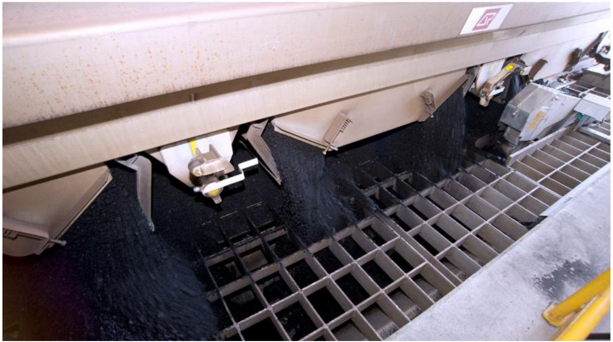
圖164 NCIG火車卸煤作業
