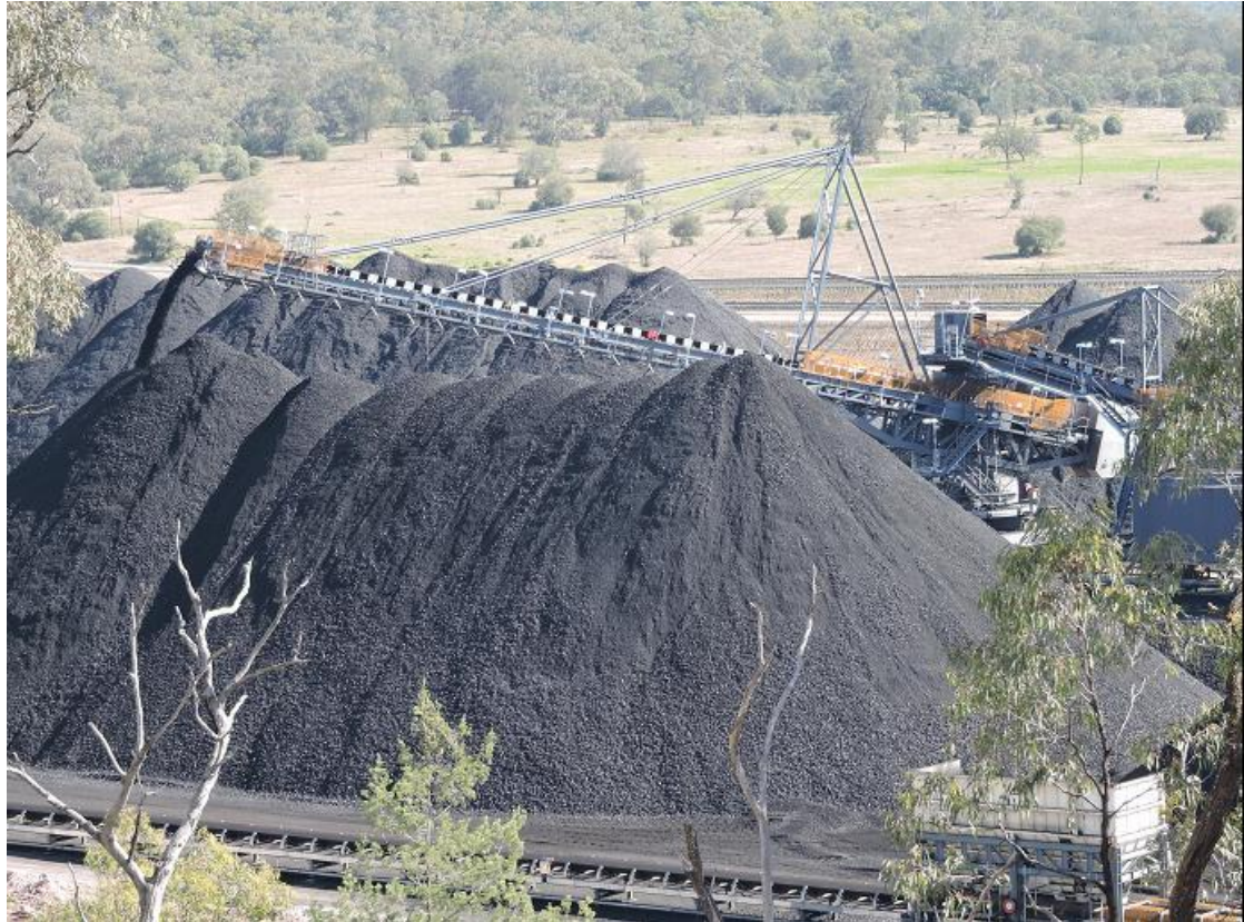
圖131 Maules Creek礦區產品煤儲煤場與堆煤機
