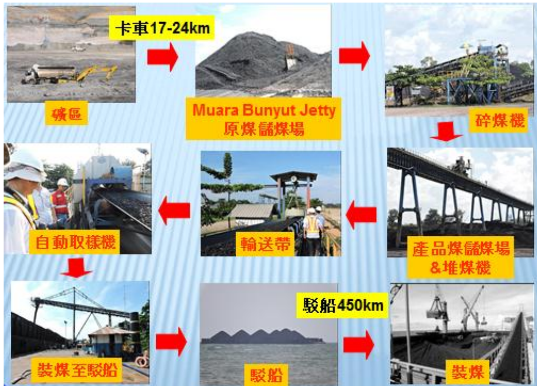
圖27 Firman Ketanun Perkasa煤礦開採運輸出口流程
