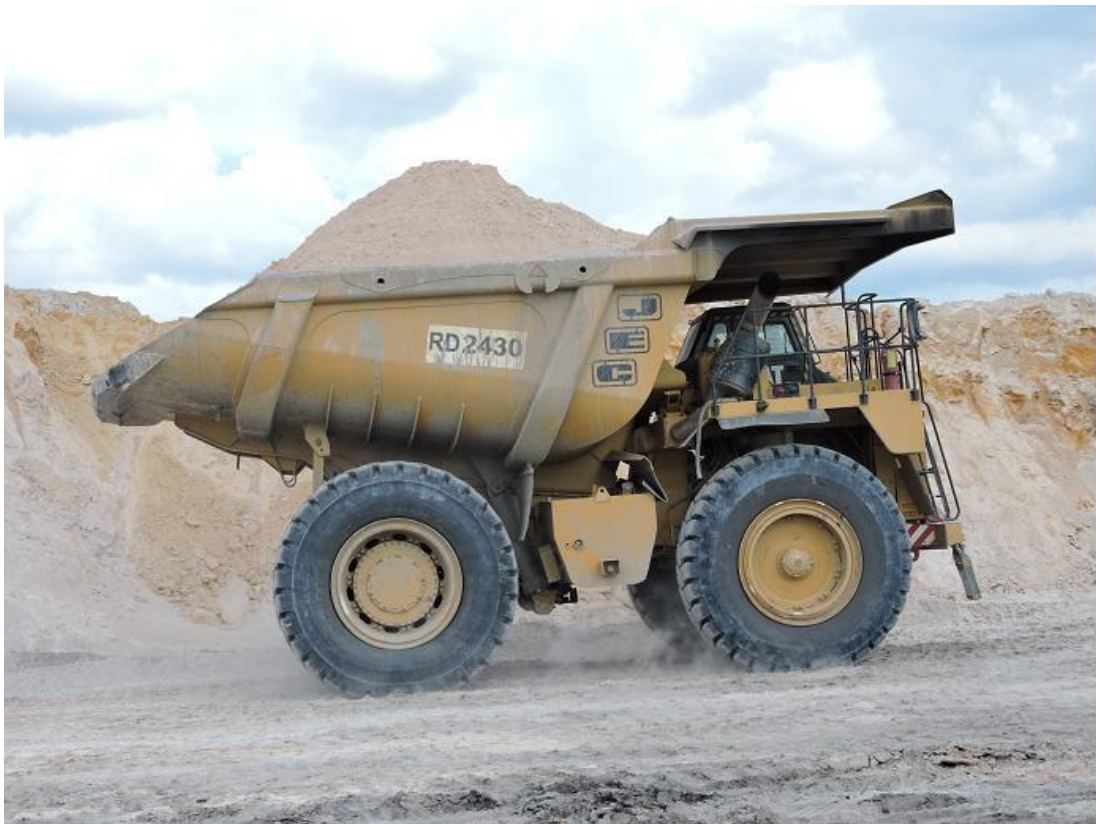
圖24 FKP礦坑搬運覆土卡車
