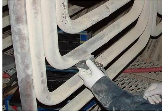
圖 2.26 自爐管外表面 LFET 掃描汽側氧化垢層堆積量
