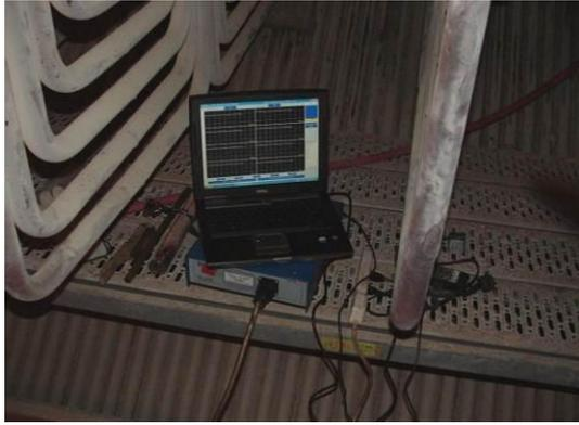
圖 2.25 LFET TUBE SCAN 系統組立
