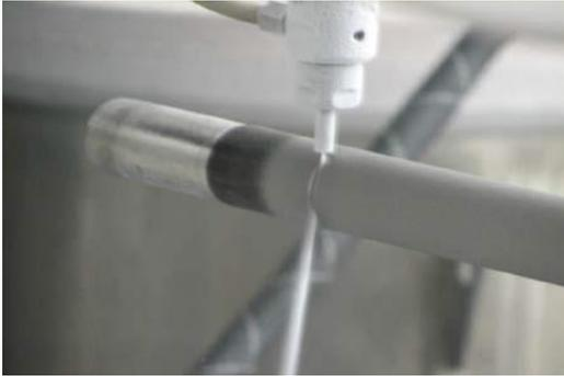
圖 4.4 精確管棒件切割
