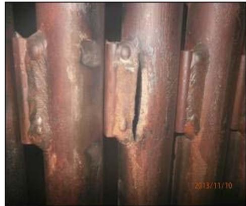
圖 2.11 固定塊破裂
