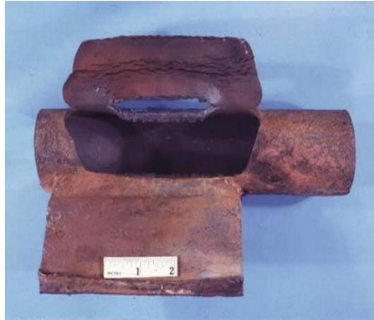
圖 2.6 爐管水側腐蝕疲勞
