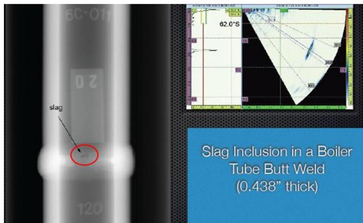
圖 2.13 夾渣(Slag) RT，UT 皆可檢出
