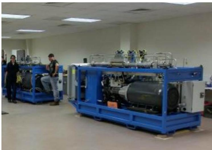
圖 3.9 氮氣噴射(NitroJet® Technology 塗層去除系統
