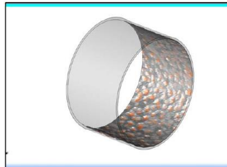
管件搭配軟體，可以顯示 3-D 掃描結果
