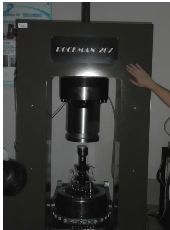
圖 22：高剛度的門框式加載框架
