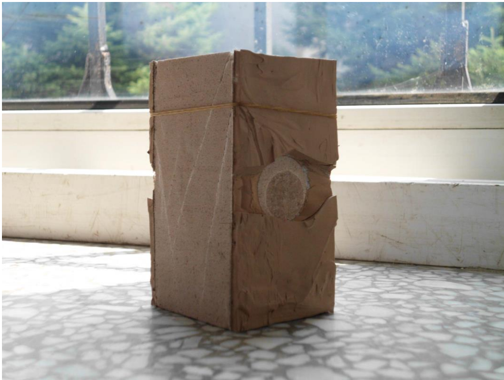
圖 16：測試後的試體樣品破壞形式
