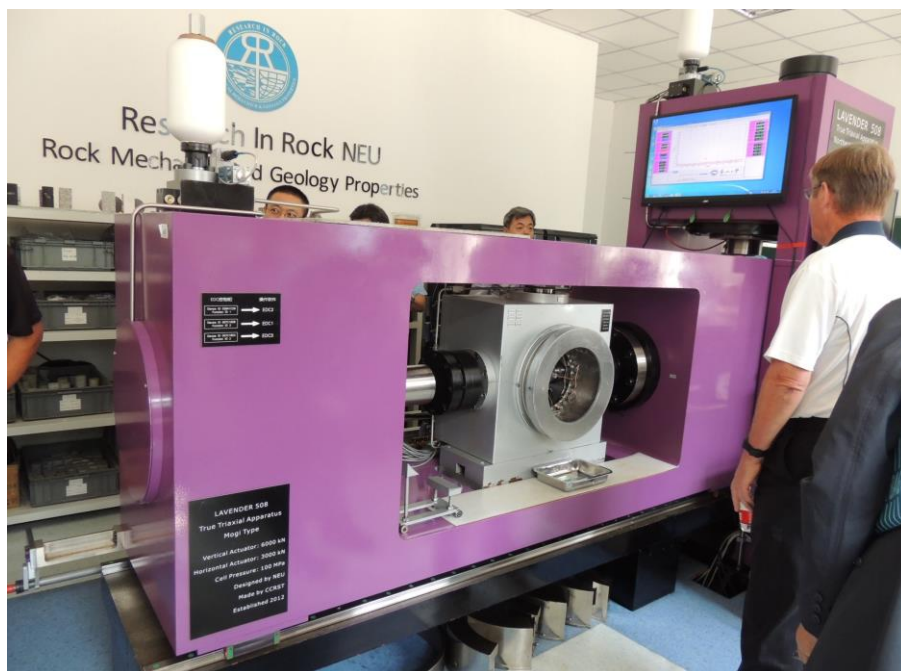
圖 13：硬岩真三軸試驗系統
