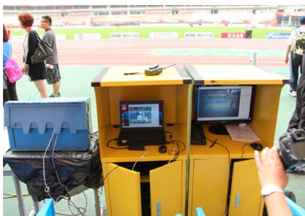
(圖 25：跳遠賽事使用的影像測距系統) (圖 26：跳遠賽事使用的影像測距系統即時畫面)
