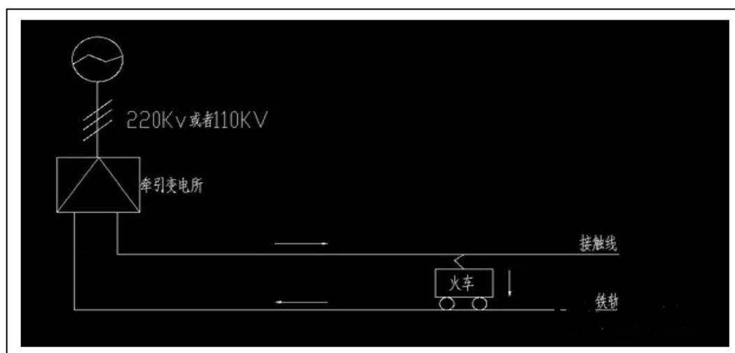
圖 4.2-5 簡單的牽引供電模型
