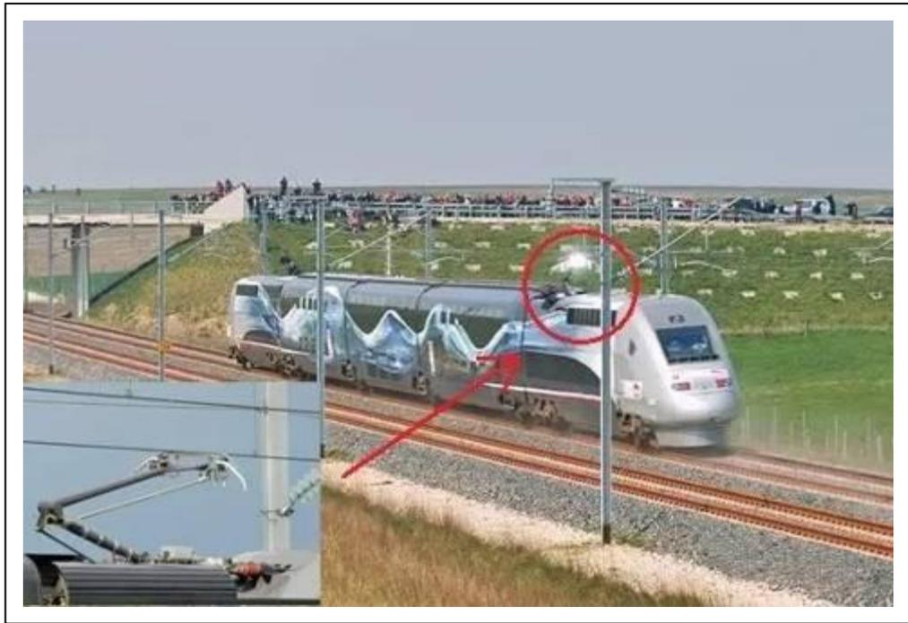
圖 4.2-11 弓網系統在高速列車牽引供電系統中的位置
