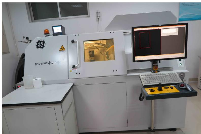
圖 10、X 射線斷層掃描成像系統。
