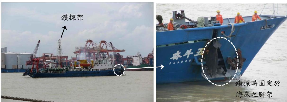
圖 4、奮鬥五號外觀及鑽探架。
