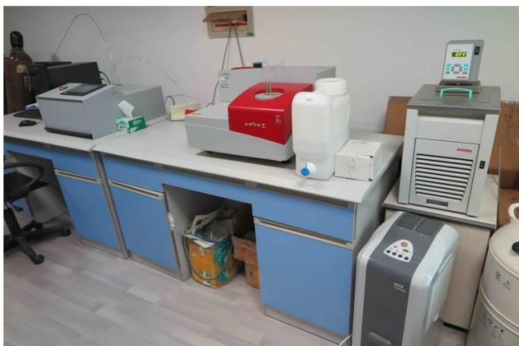
圖 11、高壓微差掃描式熱卡儀。
