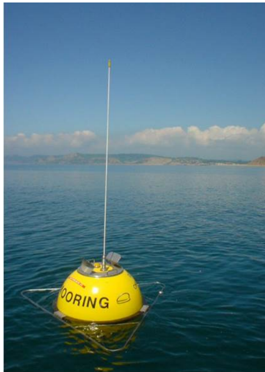
圖 13、Fugro EMU's MetOcean，利用衛星漂流浮標來進行海上氣象環境、波浪以及潮流的資訊蒐集與分析
