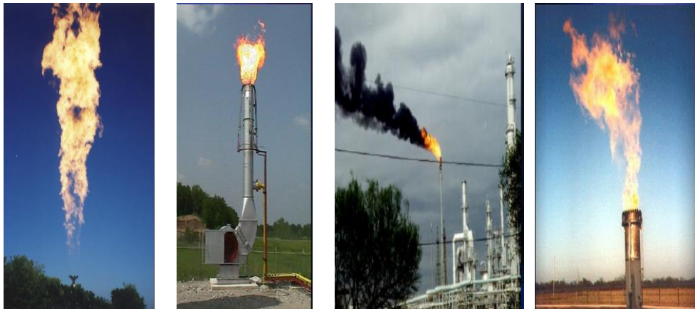
穩定，音速燃燒 空氣輔助燃燒 有黑煙燃燒
