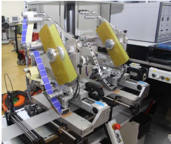
圖 26：「塊狀全像裝置(Kinegram Patch)」、「離型紙」或其他防偽裝置之自動貼合設備示意圖
