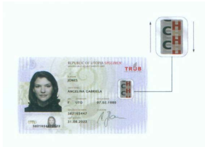
圖 11：網花式視覺動態效果視窗(tru/window™ Animation)示意圖
