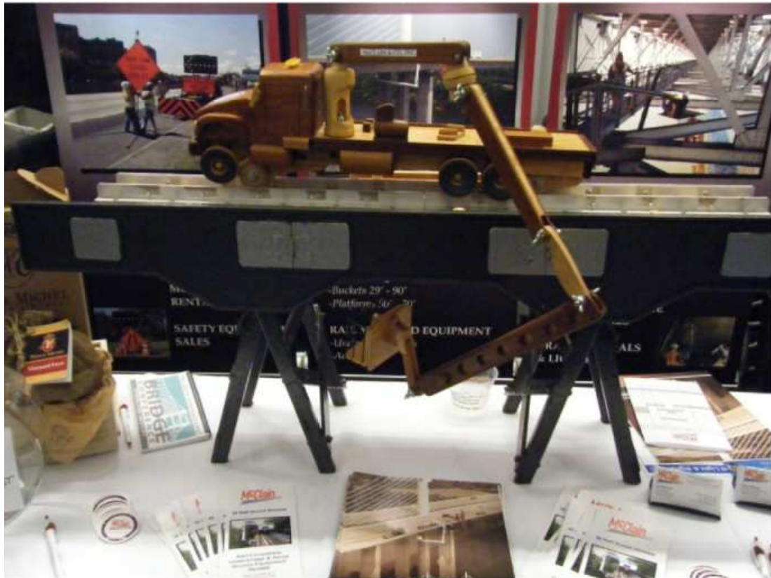
圖 4.1 鐵、公路使用的橋梁檢查車模型
