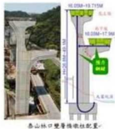
圖 3.25 雙層橋墩柱配置圖
