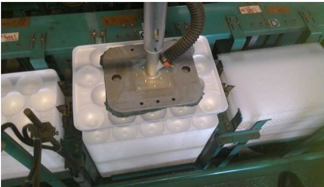
自動化機械手背吸取盛果盤於紙盒中，並由另一組吸盤手臂吸附果實置於盛果盤中
