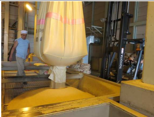
木德神糧的糙米進貨區，由農民或農協運送的糙米經檢驗後，先送至此區在移至貯藏區存放
