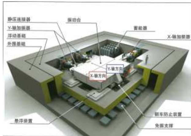
圖 5 大型振動台示意圖(摘自 RTRI 之說明資料)
