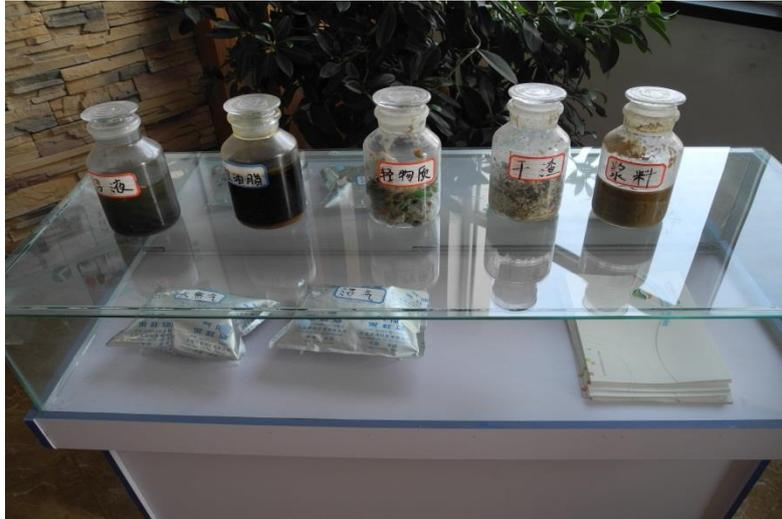
圖 2.5.5 厭氧處理流程產生之沼液、粗油脂、輕物質、乾渣、漿料（由左至右依序）
