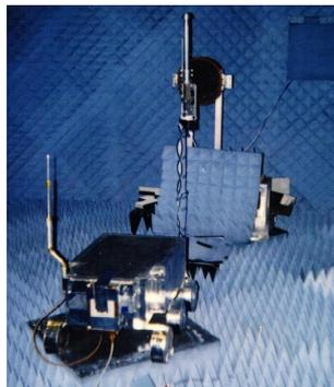
(火星探測車 EMC 試驗)
