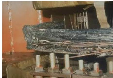
(賽勒姆核能發電廠毀壞的變壓器)
