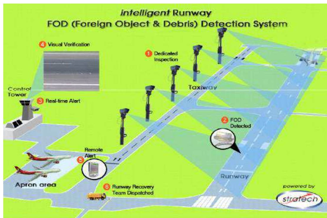
圖 6：樟宜機場 FOD 偵測系統運作示意圖(資料來源：樟宜機場集團簡報)
