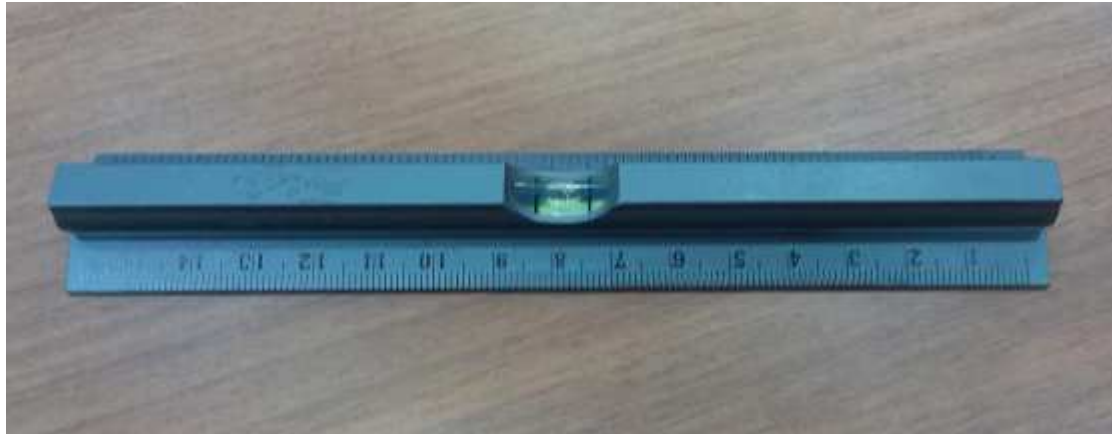
圖 2:利用已知厚度物體量測跑道積水之工具範例
