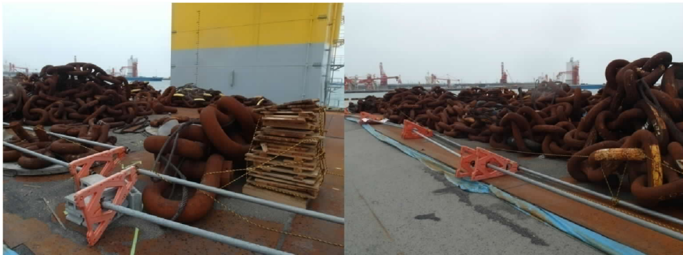
圖 41：浮台使用之錨鍊
