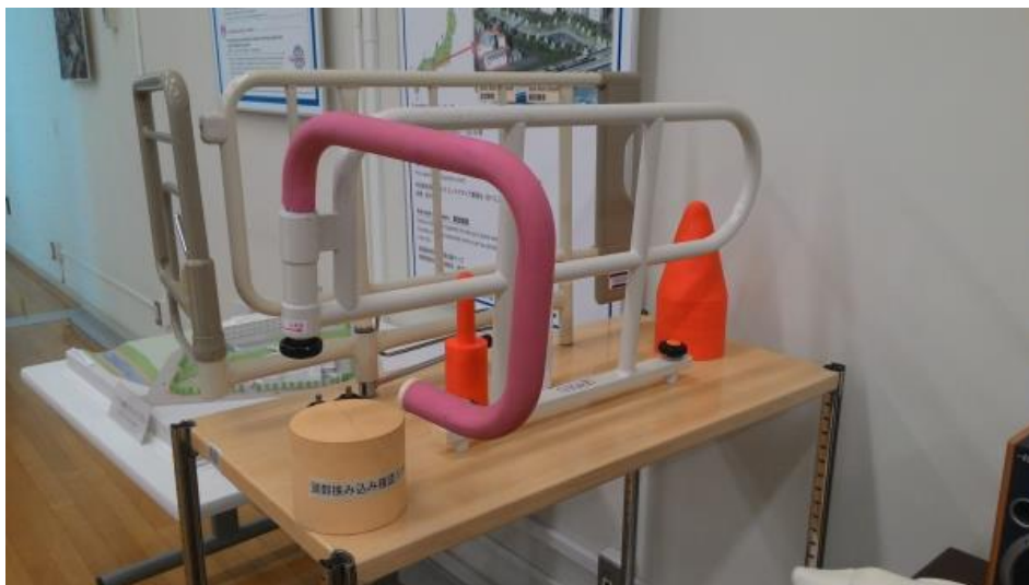
a) 適合例 円筒ゲージの上端部が、手すり部より中に入り込んでいない。
