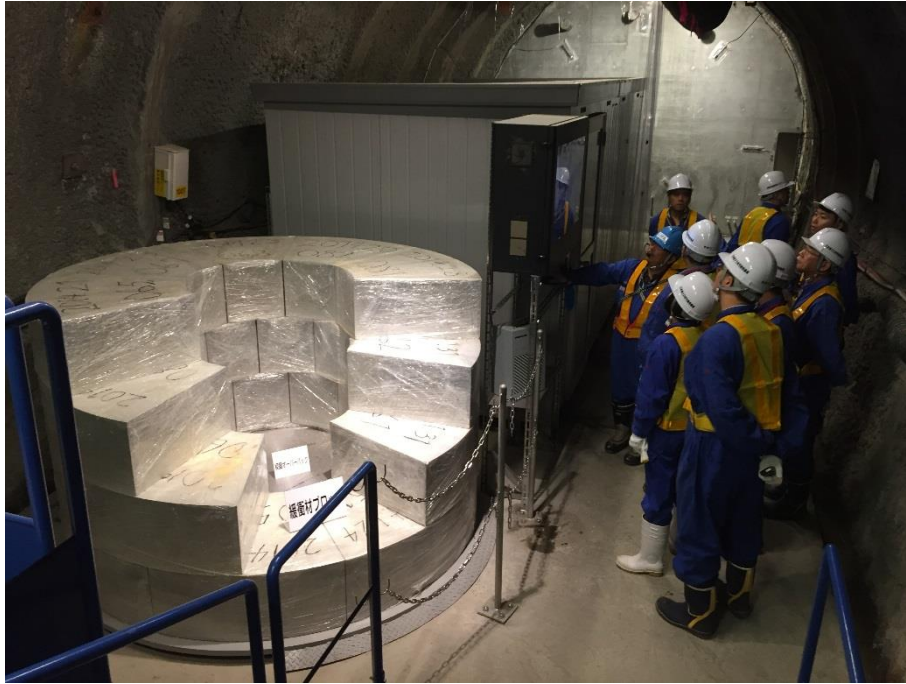
圖 24：幌延地下研究中心展示用之全尺寸緩衝材料
