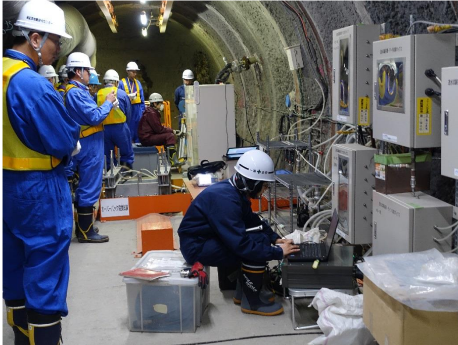
圖 20：幌延地下研究中心人員進行跨孔試驗(二)
