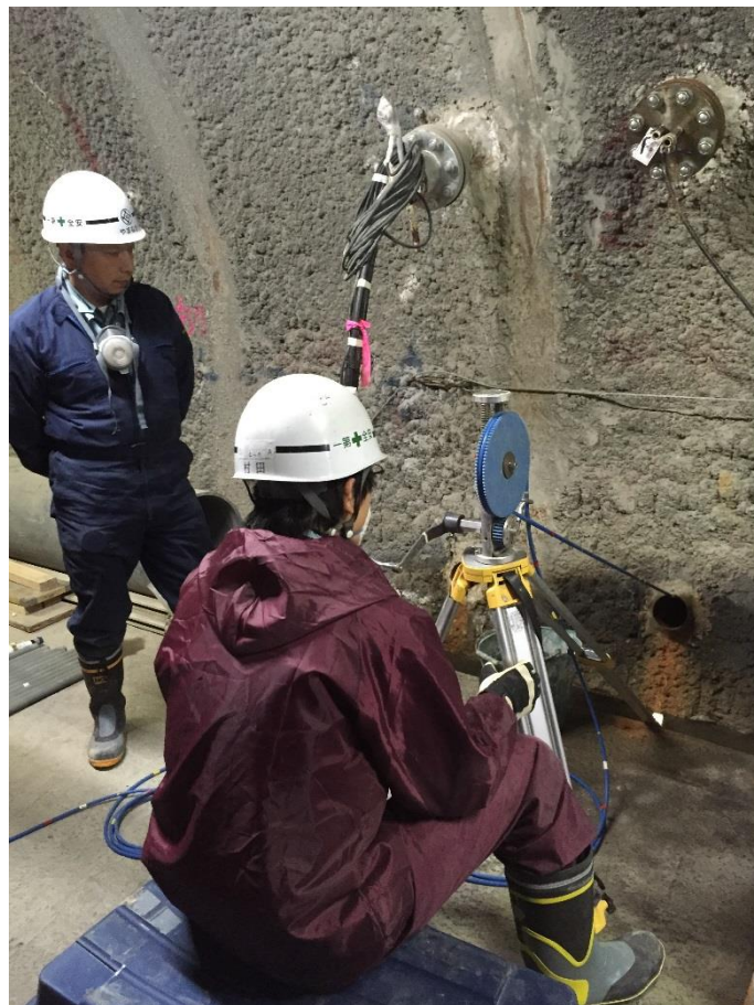
圖 19：幌延地下研究中心人員進行跨孔試驗(一)
