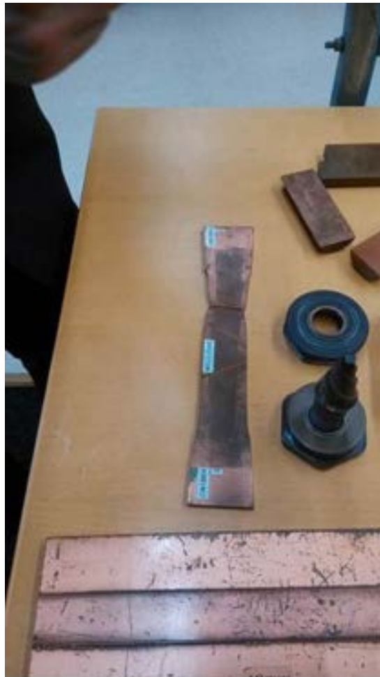
圖十四 銲接後拉力試驗之試片破壞圖
