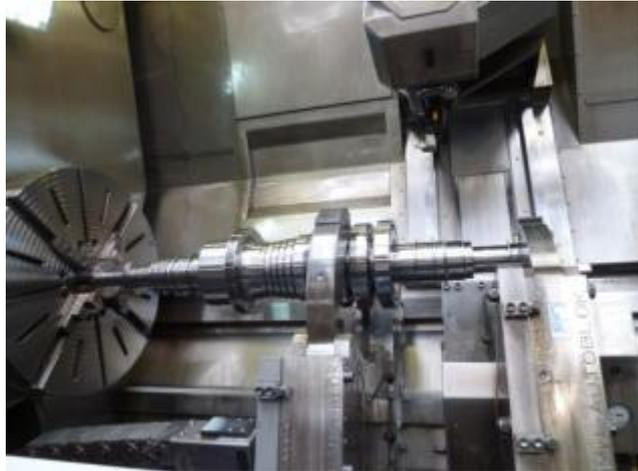
而蒸汽透平機之 blade 原始是一長方體條狀，後經加工變弧形形狀，如下圖為加工完成。
