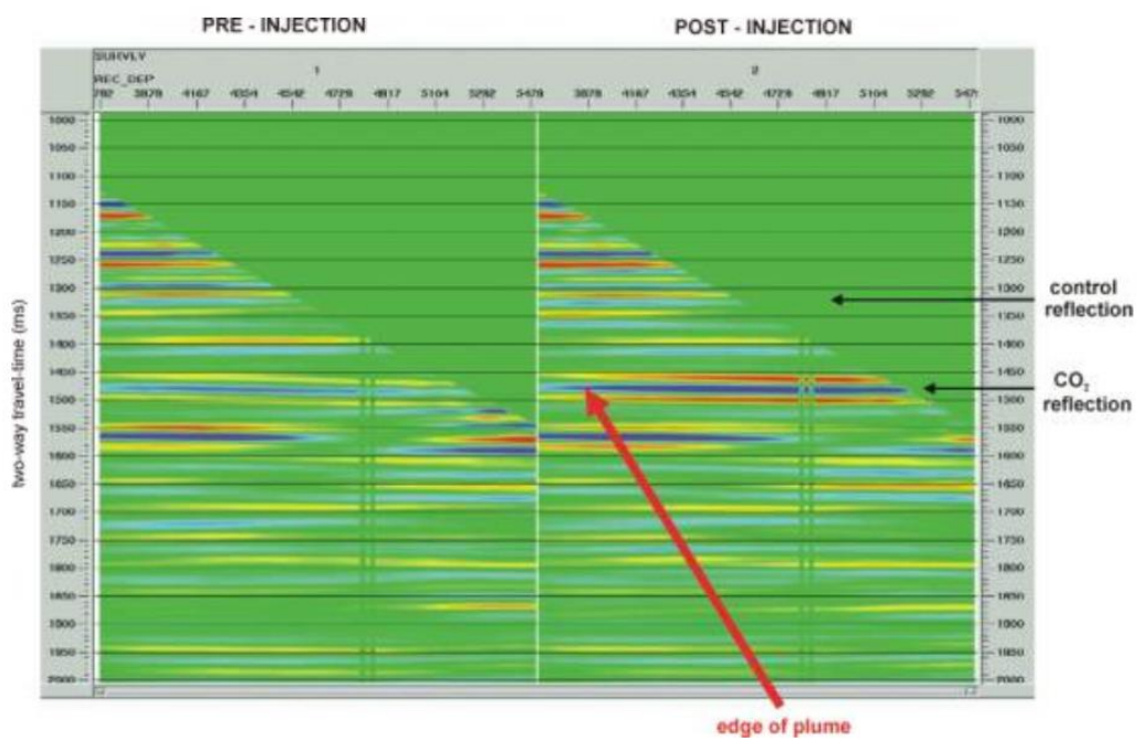
圖 24 Frio Brine Pilot study-VSP 法監測 1,500m 均質砂岩鹽水層灌注 1,600t-CO 2 成果
