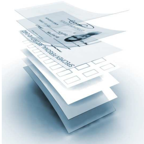
圖3.6 PC卡各層示意圖
