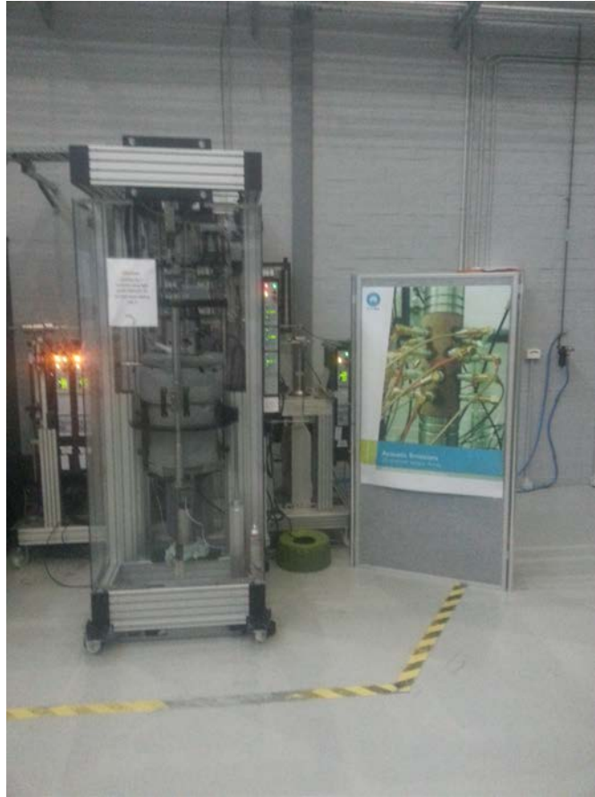
圖 5 全岩心之縱波( V_p )及剪切波( V_s )波速量測實驗室
