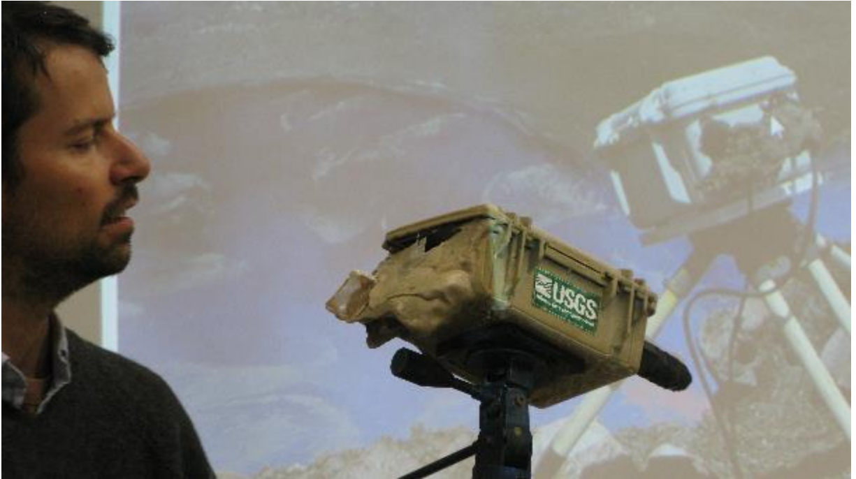
照片六、HVO 專家介紹火山監測，圖中為被熔岩高溫毀損之設備。
